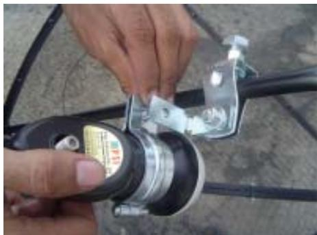
13. นำขาจับพร้อม LNB มาประกอบกับเหล็กฉาก L
