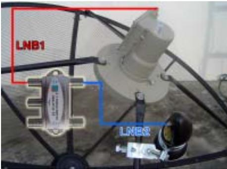
26. LNB KU-Band ต่อเข้ากับ DiSEqC 4x1 ในช่อง LNB2
